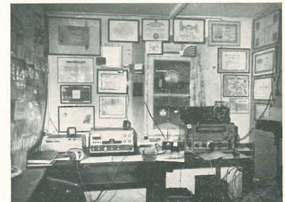
Apparecchi e diplomi. Da sinistra G651 (registratori), ricevitore G4/216 MKIII, converter Labes CMF-2 per i 144 MHz, RX a transistor per i 144 MHz, RX a copertura continua Marconi Electra a 10 tubi, RX Minerva per le OM.
