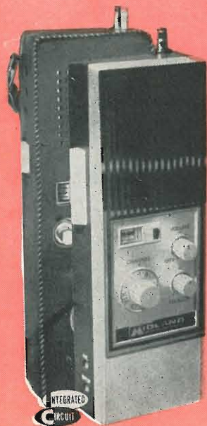
mod. 13-795 5 Watt - 23 canali
